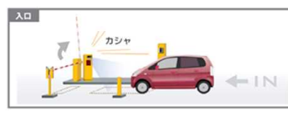
機械式ゲートの設置による不適正利用対策の事例
