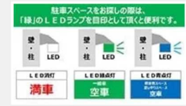
LED照明による満空表示
