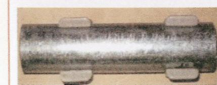
長期間の埋設により腐食した白ガス管
