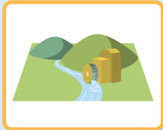
小水力発電 (単機出力1~1000KW以下)
